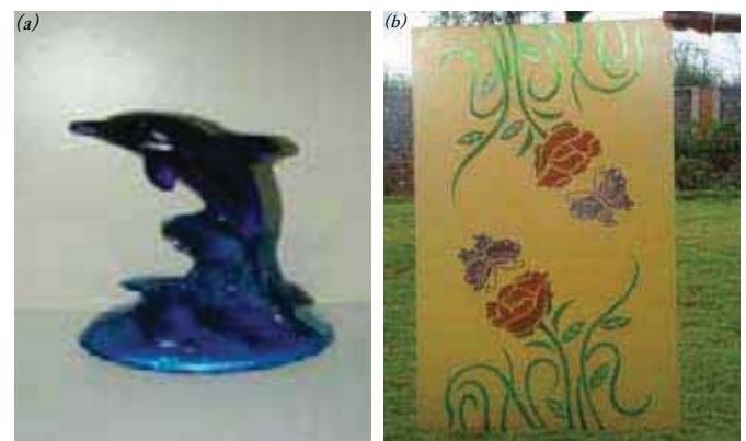
चित्र 1: सजावटी सोल – जैल कोटेड ए) ग्लास आर्टिकल और बी) अनुकूलित सोल संघटन का उपयोग कर प्लाट ग्लास शीट
