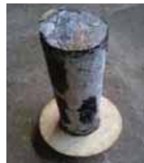
चित्र 4: एआरसीआई नमूने के इनगट जिसका इस्तेमाल प्रोटोटाइप अल्टरनेटर फॉब्रिकेटिंग के लिए किया जाएगा।
