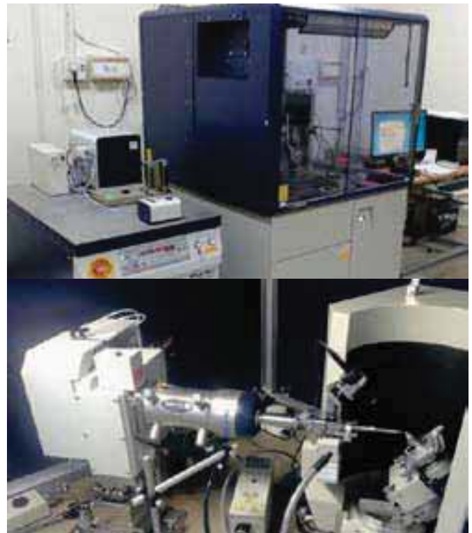
चित्र 1: (क) रैपिड-II डी/मैक्स एक्स-रे इकाई (ख) गोनियोमीटर पर स्थापित नमूना, चरण के पीछे घूर्णन एनोड, प्रकाशिकी और डिटेक्टर प्रदर्शित विन्यास।
