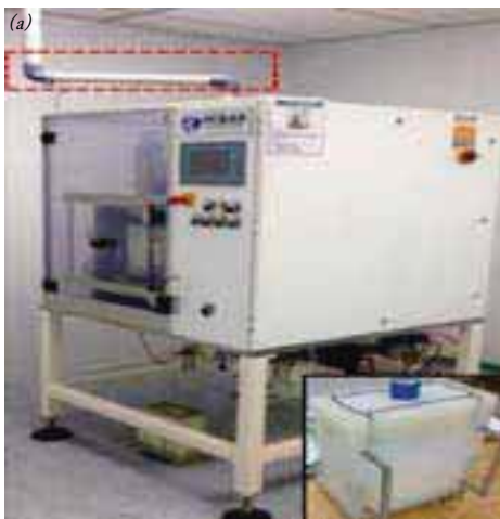
चित्र 1:(ए) फ्रेश ड्राइ एअर कनेक्शन, गोलाकार सेल सहित नेस्ट (इसट) (बी) प्रि- फिल चरण के लिए कैलिब्रेशन डेटा
