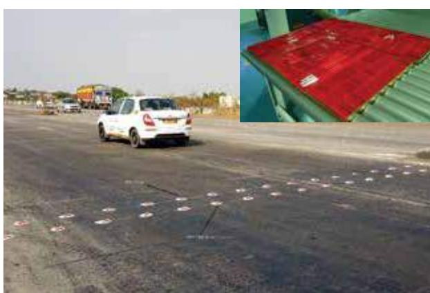
चित्र 3: क्षेत्र परीक्षण का प्रारंभिक-परीक्षण करने के लिए, सोल-जैल लेपित लैंसों और वाणिज्यिक लैंसों (500 सोल-जैल लेपित पश्चगतिक परावर्तन लैंसों के छायाचित्र दिखाया गया) को रोड स्टडों पर नियत किया गया।
