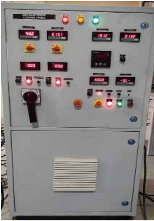
चित्र 8: एआरसीआई में अपने परीक्षण के दौरान प्रचालन में एनआईटी-तिरुचिरापल्ली को आपूर्ति की जा रही विशेष रूप से डिजाइन की गई कस्टम निर्मित एमएओ नियंत्रण प्रणाली
