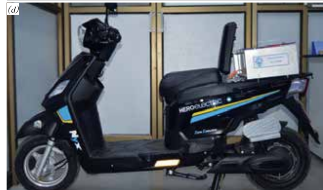
चित्र 1 (ए) 3.2 V, 18 Ah ली-आयन सांकेतिक सेल और 0.3 C दर पर इसके चार्ज/डिस्चार्ज का निरूपण, (बी) 18 आह Ah के चक्रीय निष्पादन, (सी) बैटरी प्रबंधन प्रणाली (बीएमएस) के साथ 850 Wh बैटरी पैक, (डी) 850 Wh बैटरी पैक के साथ ई स्कूटर का निष्पादन।
