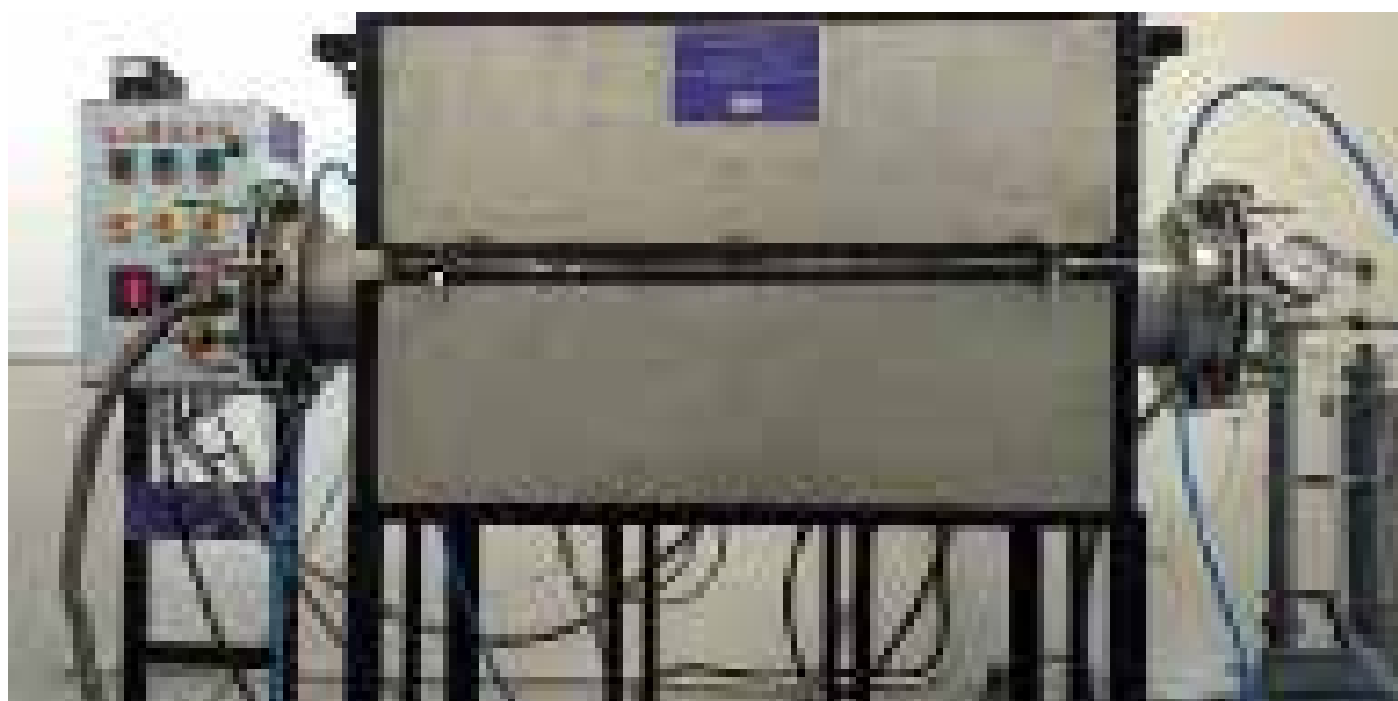
बड़े पैमाने पर 2डी-टीएमएस का उत्पादन करने के लिए एआरसीआई में स्थापित स्केल-अप रिएक्टर
