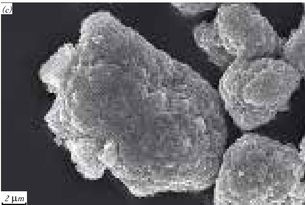
चित्र 4: (ए) निरंतर द्रवित रिएक्टर का उपयोग कर \text{NMC}(\text{OH})_2 तैयार किए गए, (बी) \text{NMC}(\text{OH})_2 के एसईएम सूक्ष्म-ग्राफ, (सी) LNMC नैनो/सूक्ष्म पदानुक्रमिक संरचना को दर्शाता है, (डी) ग्रेफाइट सहित \text{LiNi}_{1-x-y}\text{Co}_x\text{Mn}_y\text{O}_2 एवं \text{C}-\text{LiNi}_{1-x-y}\text{Co}_x\text{Mn}_y\text{O}_2 की चार्ज/डिस्चार्ज प्रोफाइल
