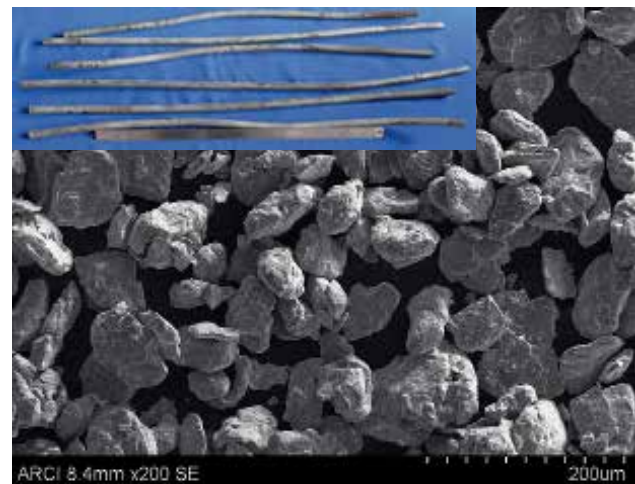
चित्र 6 : मिल्ड ओडीएस आरएफएम-9 सीआर इस्पात पाउडर एसआईएम चित्र। इनसेट में इसी पाउडर का उपयोग से उत्पन्न उत्सारित की गई रॉड को दर्शाया गया है।
