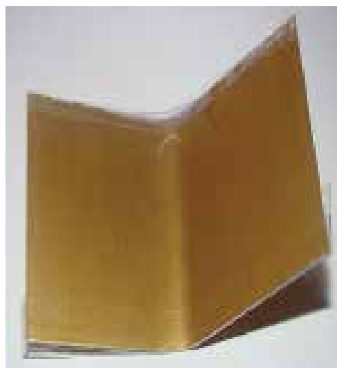
एए2024 टी3 मिश्र-धातु पर लागू क्रोम-मुक्त पर्यावरण-अनुकूल विलेपन स्टैक लेपित किया गया, साल्ट स्त्रे परीक्षण के 336 घंटे के बाद, झुकाव बिंदुओं पर कोई संक्षारण नहीं दिख रहा है
