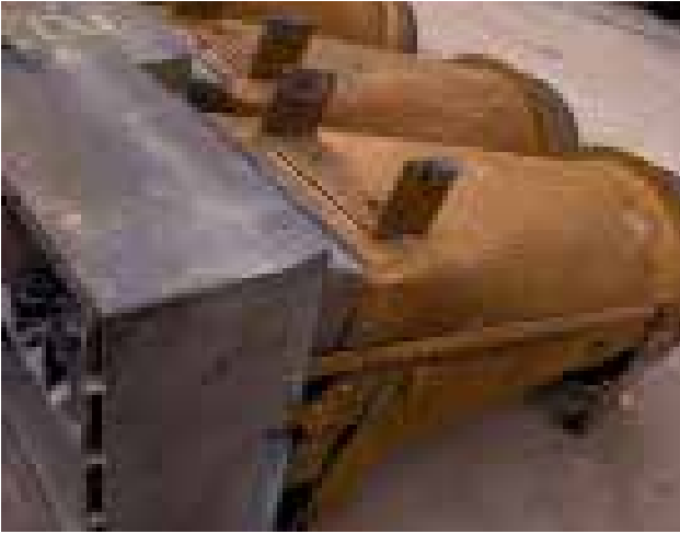
चित्र 7: इरोज़न-कर्रोज़न द्वारा प्रभावित कोल-आधारित क्रिटिकल/सूपर थर्मल पावर प्लान्ट में प्रयोग किए गए तनाव-रहित ब्याअलर भाग
