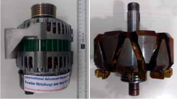
नरम चुंबकीय सामग्री का उपयोग कर विकसित प्रोटोटाइप क्लाय पोल अल्टरनेटर और क्लाय पोल रोटर
