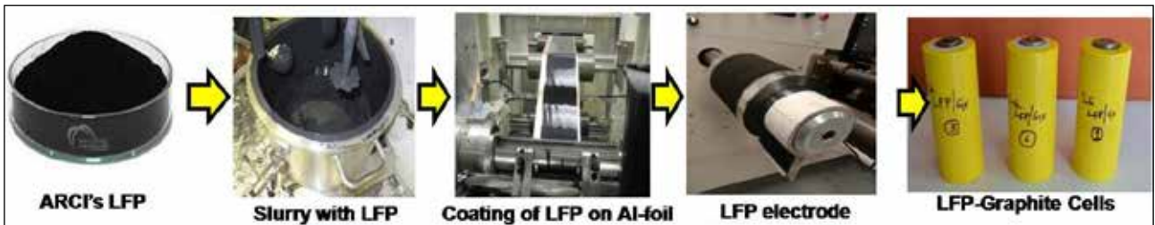
चित्र 1: लीथियम-आयन फॉस्फेट आधारित लीथियम आयन बैटरी उपकरणों के निर्माण के लिए योजनाबद्ध प्रस्तुतिकरण
