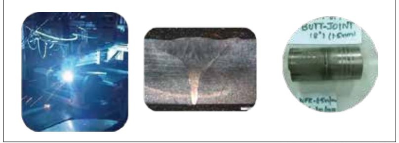
चित्र 4. लेजर हाइब्रिड वेल्डिंग (LHW) के लिए प्रायोगिक स्थापना; IN617 वेल्ड सूक्ष्म संरचना; LHW ट्यूबलर कूपन
