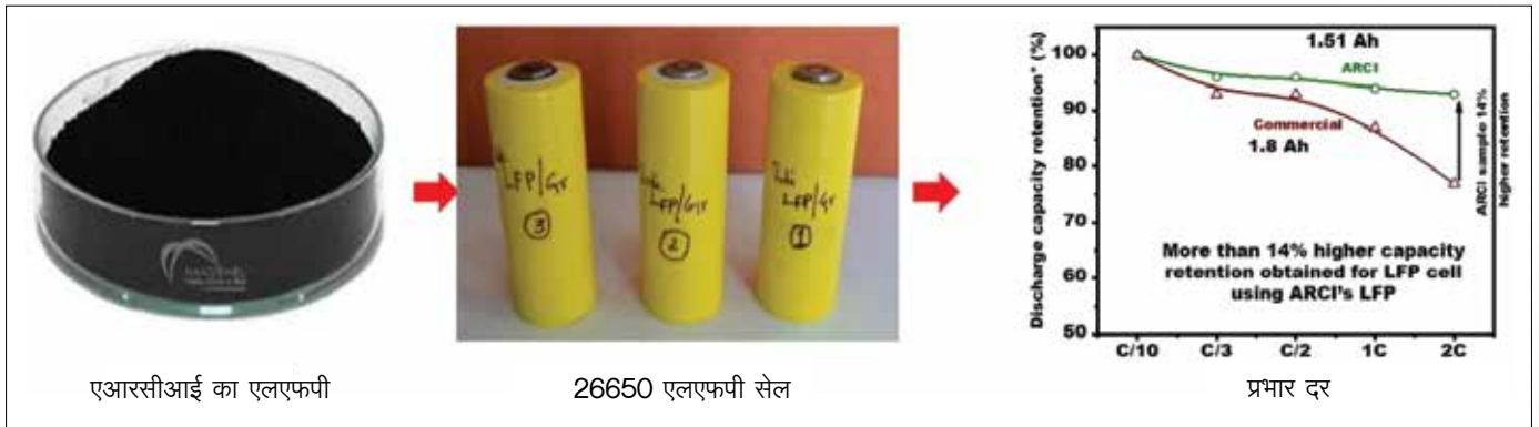
चित्र. एआरसीआई के लीथियम फेरोफॉस्फेट का उपयोग कर 26650 लीथियम फेरोफॉस्फेट सेलों की संविचरणा, जो एआरसीआई के लिए एक बड़ी उपलब्धि है
