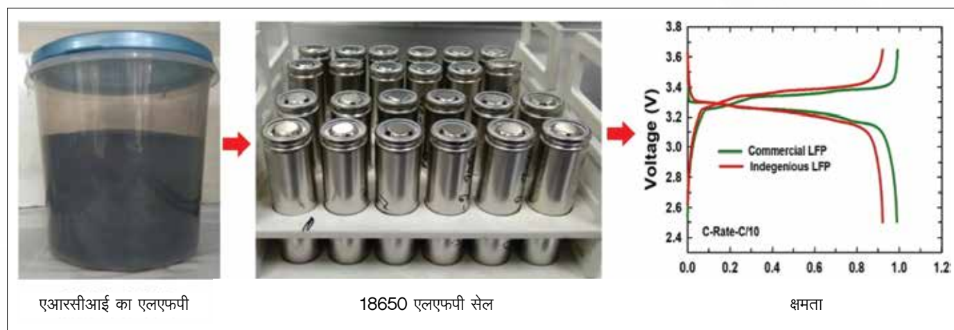
चित्र. एआरसीआई के लीथियम फेरोफॉस्फेट का उपयोग कर, 18650 लीथियम फेरोफॉस्फेट सेलों का निर्माण
